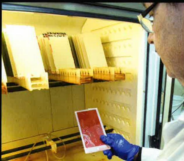
25 personnes de l'ESAT de Dainville réalisent la tampographie en plusieurs langues des couvercles, une fois leur passage en cabine de peinture.
