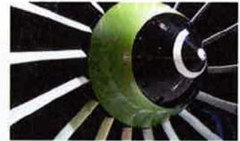
Aubes carbone moteur LEAP.
